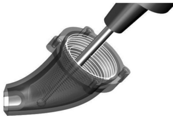
Рис. 11. САМ-симуляция процесса обработки детали на пятикоординатном фрезерном станке с числовым программным обеспечением Источник: (Siemens PLM, 2021).
